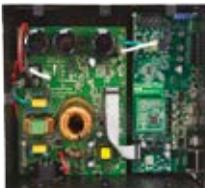
Questo sistema ad alta tensione è pensato per aiutare gli utilizzatori in una rapida valutazione e sviluppo di una grande varietà di applicazioni di controllo motori per mezzo di DSC dsPIC. Questo sistema di sviluppo è mirato al controllo di motori BLDC,
