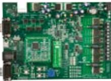
Questa scheda di sviluppo a bassa tensione offre una modalità conveniente per la valutazione e sviluppo di applicazioni per motori Brushless DC (BLDC), sensored o sensorless, e Permanent Magnet Synchronous Motor (PMSM). La
