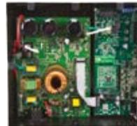
Questo sistema ad alta tensione è pensato per esserti di aiuto nella rapida valutazione e sviluppo di una grande varietà di applicazioni di controllo motori mediante un DSC dsPIC. Questo sistema di sviluppo è mirato al controllo di motori BLDC,
