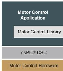
Le Motor Control Library contengono blocchi funzionali ottimizzati per le famiglie di DSC dsPIC33F e dsPIC33E. Tutte le funzioni in questa Motor Control Library hanno input(s) e output(s), ma non fanno accesso a nessuna periferica DSC. Le funzioni della libreria sono state progettate
