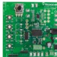
Questa scheda di valutazione contiene commutatori con pulsanti a pressione e un potenziometro di input per il controllo variabile della velocità per la dimostrazione del MTS2916A nel controllo di un motore stepper in full-step, half-step, modified half-step e micro-stepping.
