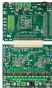
Questo bundle fornisce un conveniente metodo di valutazione e sviluppo per controllo motore duale/singolo per pilotare motori BLDC o PMSM contemporaneamente, oppure uno per ciascun tipo di motore. La dsPIC DSC Signal Board supporta dispositivi sia alimentati a 3,3V che 5V per varie applicazioni e interfacce umane utilizzate con frequenza tra cui alcune funzionalità ed interfacce di comunicazione. La
