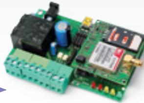
*Il circuito permette, da remoto, di gestire due utilizzatori o verificare lo stato di vari apparati, sia mediante SMS, sia usando il DTMF da tastiera.*
